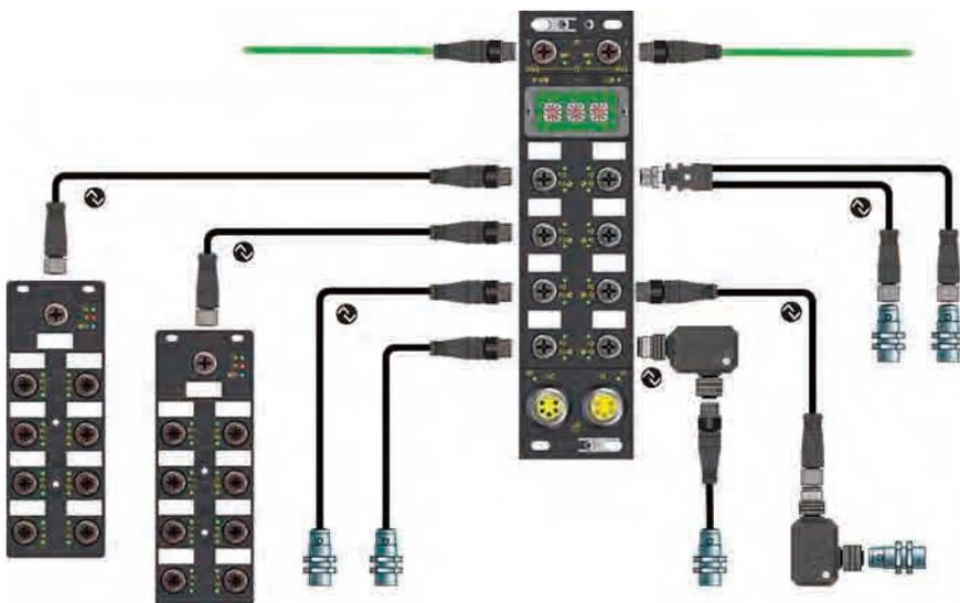
Типовая схема подключения по технологии IO-link
